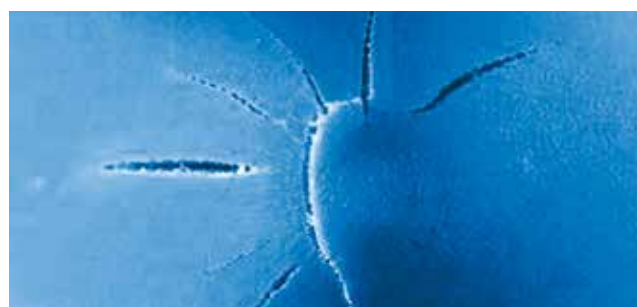
Poškození dlouhodobým působením napětí
