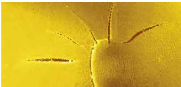
Poškození dlouhodobým působením napětí
